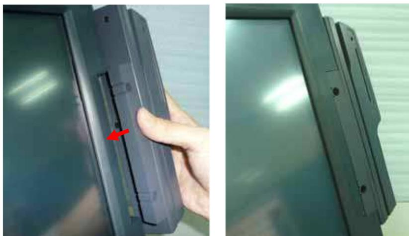
6. Обрато завинтите два винта, чтобы надёжно закрепить модуль MSR.
