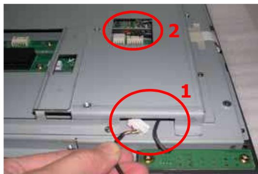
11. Соедините второй конец кабеля с соответствующим разъёмом на плате ЖК-панели.
