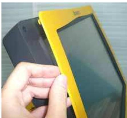
4. Переверните терминал и удалите четыре обозначенных винта, чтобы отсоединить основную крышку и крышку дополнительного дисплея.
