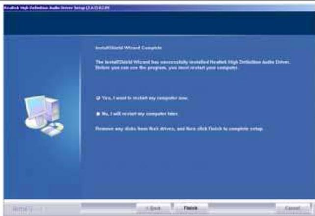
4. После завершения установки нажмите Finish для перезагрузки системы.
