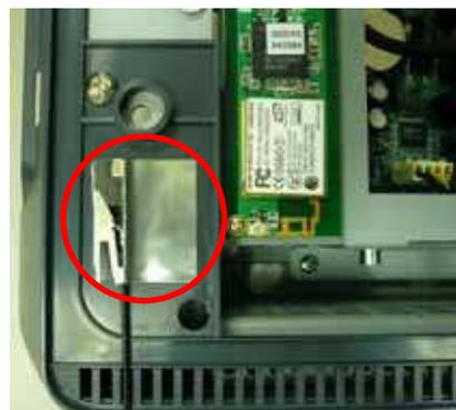
8. Протрите второй конец антенны через круглое отверстие и соедините его с модулем WiFi.
