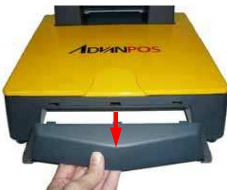
4. Переверните терминал и удалите два обозначенных винта, чтобы снять защитную крышку от крепления дополнительного дисплея.
